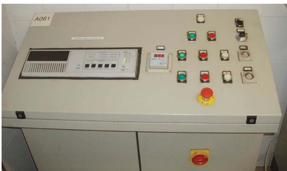
Particolare della consolle di controllo: la consolle permette di gestire tutti i parametri di estrazione in modo immediato; da qui possono essere regolati la durata del processo, la velocità di agitazione, la frequenza degli ultrasuoni
