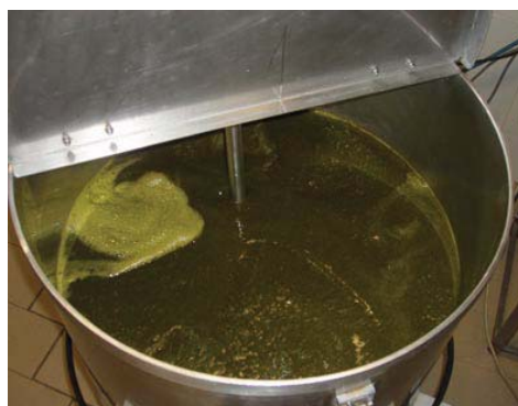
Particolare dell'interno in esercizio: dopo due ore circa dall'avvio del processo è già possibile notare come l'acqua di estrazione si sia "caricata" dei principi attivi del vegetale. La soluzione estrattiva si presenta già densa ed intensamente colorata.
